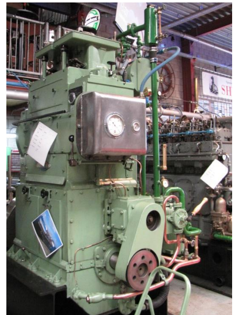
Gelaste uitvoering van 2-cylinder Bolnes, broederlijk naast de gietijzer uitvoering, werkend volgens het principe 2-tact langsspoeling met uitlaatklep
