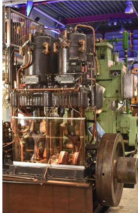
Gietijzer uitvoering van 2-cylinder kruiskop Bolnes werkend volgens het principe 2-tact omkeerspoeling met uitlaatpoorten
