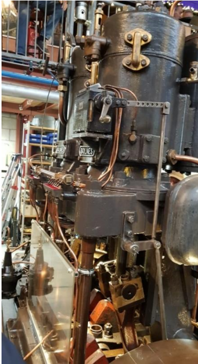
Gietijzer uitvoering van 2-cylinder kruiskop Bolnes werkend volgens het principe 2-tact omkeerspoeling met uitlaatpoorten
